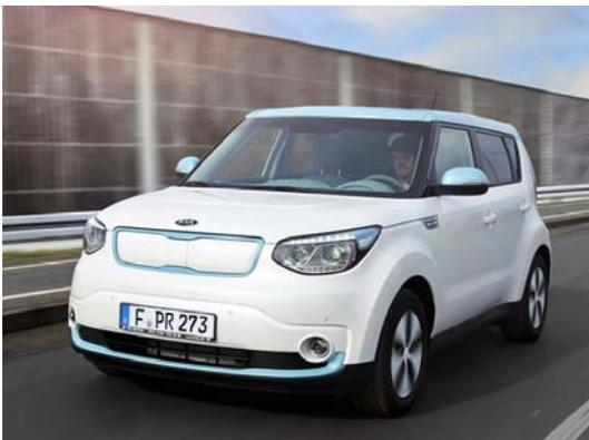
La carrocería tipo SUV no es la más adecuada en términos de eficiencia, por su altura y formas más bien cuadradas sin tercer volumen. Tiene pocas optimizaciones y parte de una carrocería convencional. La media de consumo es 17 Kwh/100 km, por lo que lograr los 179 kilómetros de autonomía según la EPA es relativamente sencillo.
