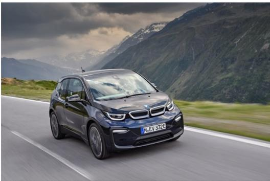
El subcompacto Premium se diferencia de sus competidores por una mayor potencia (170 CV en modelo base) y la posibilidad de instalar un extensor de autonomía de gasolina (REX) para no sufrir cuando las baterías anden justitas. Aerodinámicamente no es tan brillante, pero sí a nivel estructural, usando mucha fibra de carbono pesa casi lo mismo que un utilitario diésel, y también usa neumáticos de formas muy atípicas (altos y estrechos). ¿La pega? El precio.
