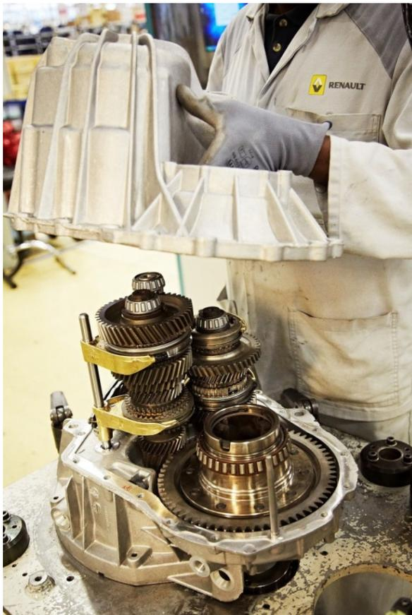
La caja de cambios va asociada a los motores térmicos pero ¿qué ocurre con los eléctricos? Simplemente, no la necesitan. Veamos por qué este sencillo tipo de motor permite simplificar la mecánica, eliminando este complejo sistema de transmisión de relación variable, que es la caja de cambios.
