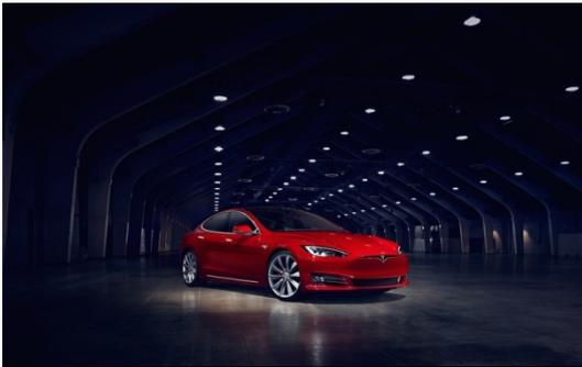
El gran sedán de Tesla no se caracteriza por un consumo bajo, pero se explica rápidamente por su elevada potencia (422 CV) y peso, aunque lo compensa con una gran autonomía (632 km) gracias a baterías muy grandes (100 Kwh), a una aerodinámica excelente, y a una red de supercargadores que le permiten viajar con pausas muy breves.
