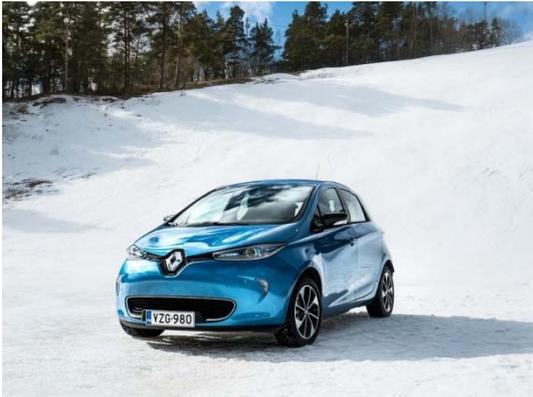
El superventas francés amplió recientemente sus baterías en el modelo alto de gama de 22 a 41 Kwh, casi el doble, por lo que puede hacer tranquilamente 200 kilómetros sin reparar en la conducción. Apurando mucho se puede llegar a 300 km, pero nunca a los 400 km homologados. A falta de homologación EPA, contamos el valor NEDC únicamente.
