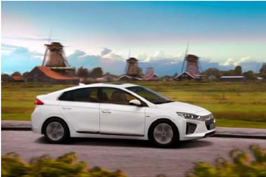
El ganador es un coreano que se diseñó como híbrido, híbrido enchufable o eléctrico. La carrocería es aerodinámicamente óptima, un Kammback, con un Cx de 0,24. Aunque no brilla en materiales ligeros o neumáticos estrechos, es claramente el más ahorrador según NEDC y según EPA. Es muy factible hacer 200 kilómetros con una carga, sin tener
