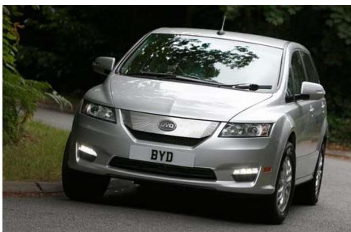
El BYD E6 es un modelo de coche eléctrico veterano, que vio la luz en China en 2010. Es un monovolumen que a cambio de ser bastante pesado (más de 2,3 toneladas) incluye una batería de 82 Kwh de capacidad que le permite tener una autonomía NEDC de 400 km, que vendrían a ser unos 300 km en el nuevo ciclo de
