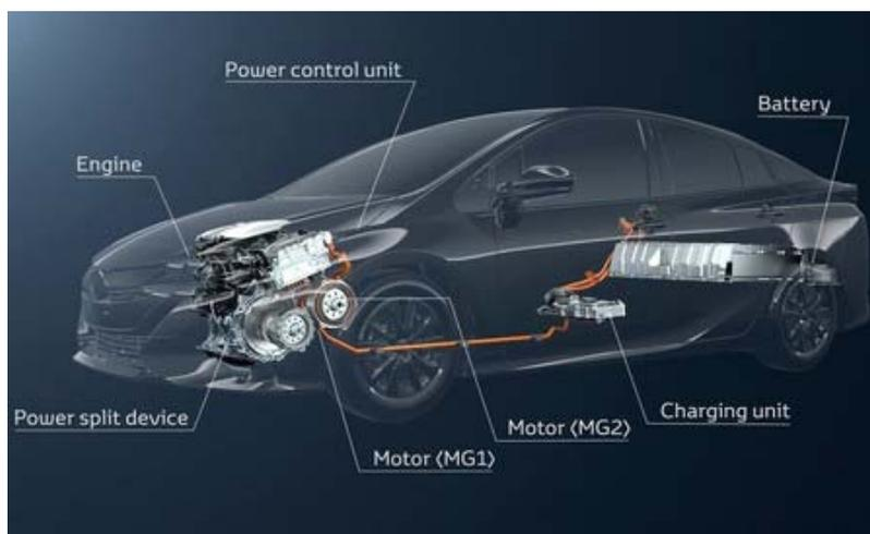
Si ves la ficha técnica del Toyota Prius, por ejemplo, encontrarás que el motor de combustión genera 96 CV y que el eléctrico produce 71 CV, sin embargo, la potencia final no es de 167 CV, sino de 121 CV. La razón es que el motor
