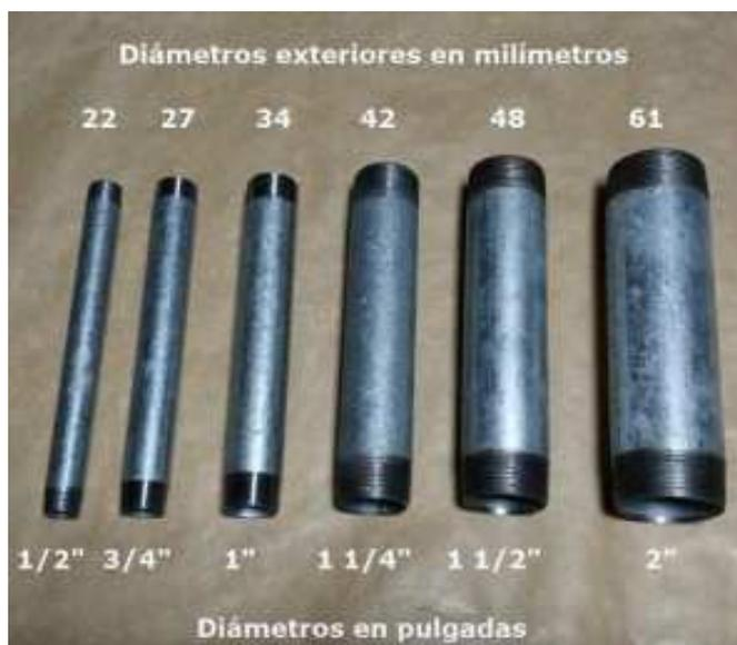
En la imagen se puede ver lo que mide en milímetros el tubo de acero galvanizado desde 1/2" a 2", son medidas exteriores, del tubo no de la rosca, que es algo inferior.
