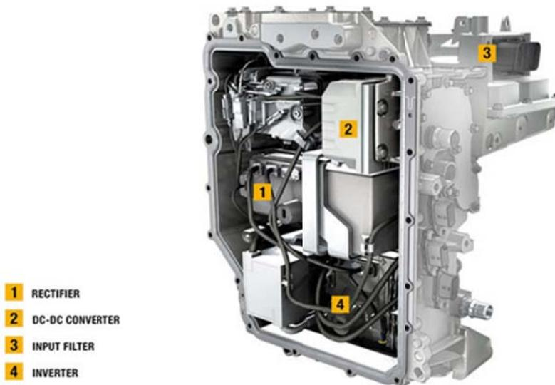
El regulador eléctrico se trata realmente de un sistema compuesto por varios subsistemas eléctricos y electrónicos llamados inversor, rectificador y transformador.
