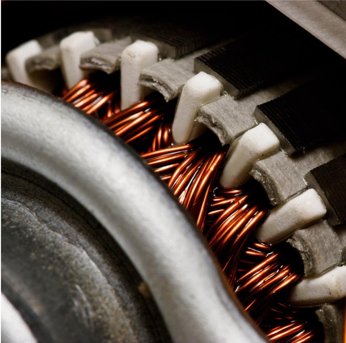
Dicho de otra manera, es el lugar donde los campos magnéticos hacen el trabajo generando las fuerzas de giro que impulsan el vehículo. Para ello, en la parte fija o estator, se inducen los campos magnéticos variables para dar el impulso de giro al rotor, única parte móvil del motor, sobre el que se crea la potencia motriz y se encarga de transmitirla a exterior del motor.
