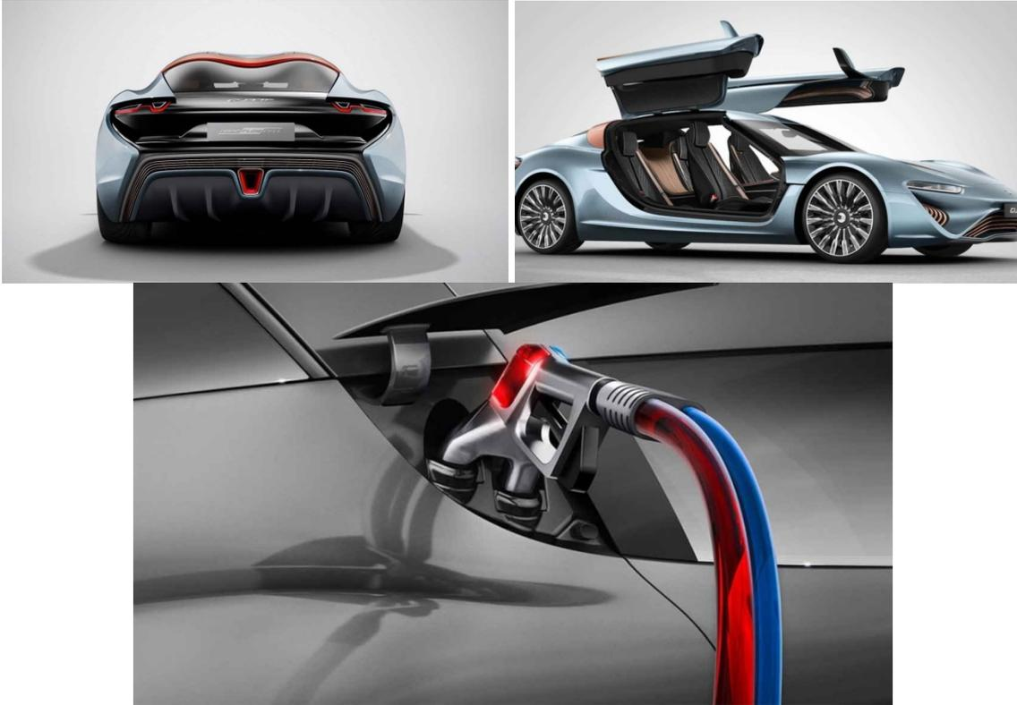
La energía almacenada ya no depende del tamaño de la celda. Aquí es donde una celda de flujo difiere de los tipos tradicionales de batería. Con NanoFlowcell, la cantidad de energía disponible depende de la concentración de electrolito en el líquido electrolítico y del volumen del tanque de electrolito.
